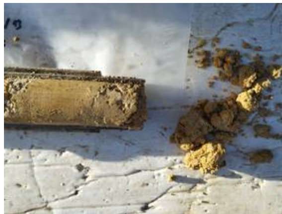
Vistes dels materials del subsòl extrets en quatre assaigs SPT realitzats al llarg del sondeig S-1.
