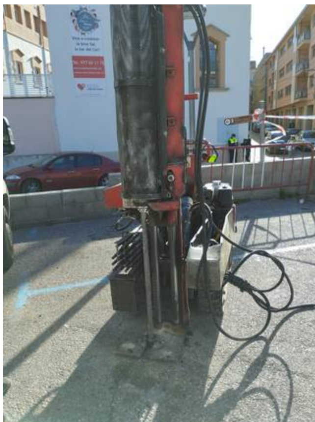
Vistes de quatre dels vuit sondeigs realitzats a la parcel·la objecte d'estudi, P-5, P-7 i P-8 del tipus DPSH i, S-7 del tipus Rotació helicoidal.
