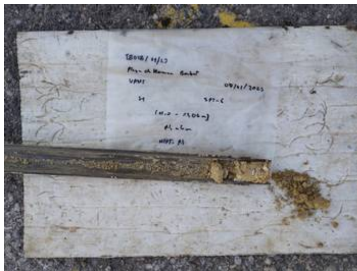
Vistes dels materials del subsòl extrets en dos assaigs SPT realitzats al llarg del sondeig S-1.
