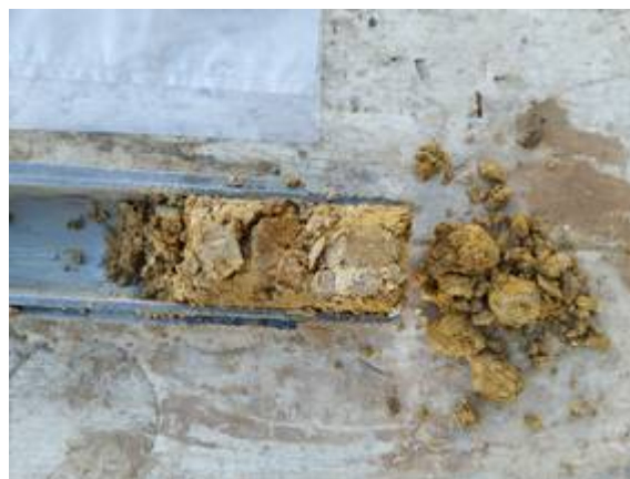
Vistes dels materials del subsòl extrets en quatre assaigs SPT realitzats al llarg del sondeig S-3.
