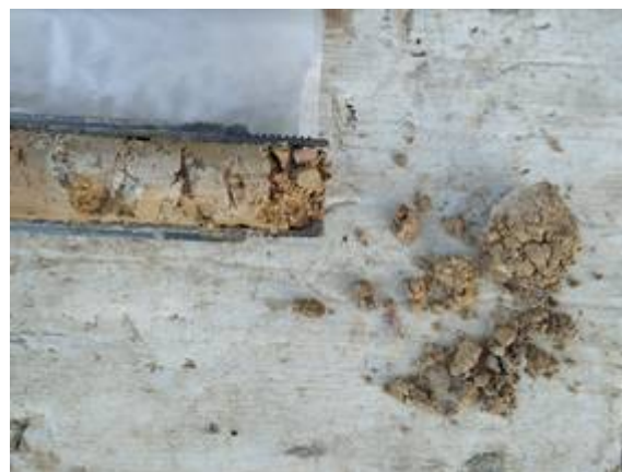
Vistes dels materials del subsòl extrets en quatre assaigs SPT realitzats al llarg del sondeig S-4.
