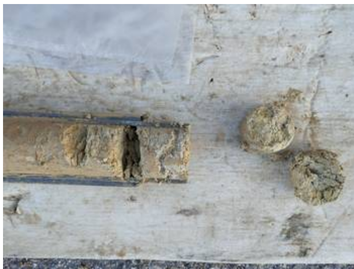
Vistes dels materials del subsòl extrets en un assaig SPT realitzat al llarg del sondeig S-4.
