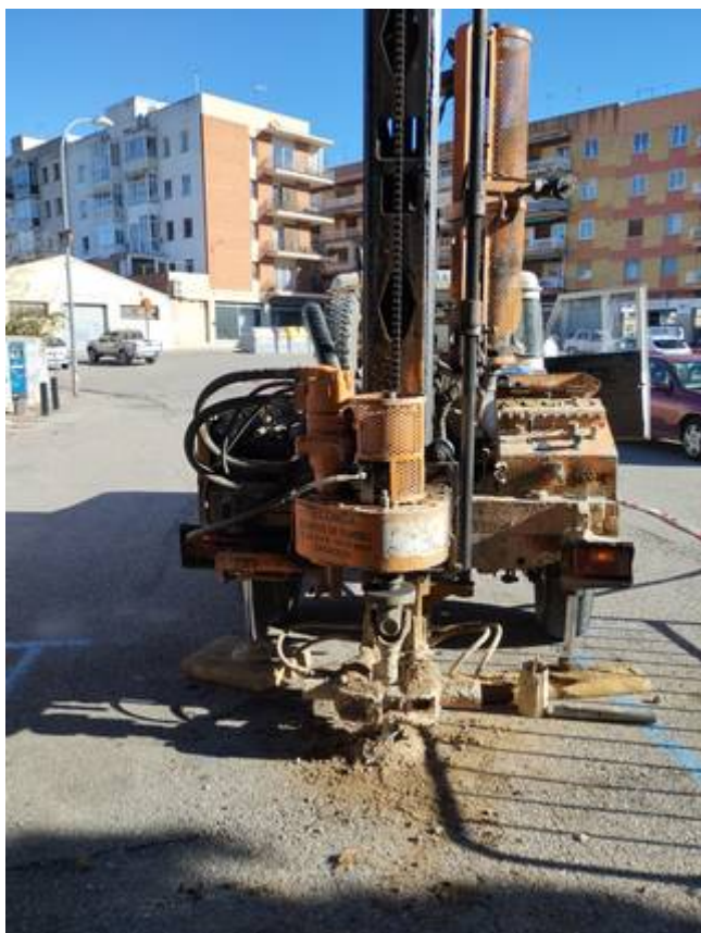
Vistes de quatre dels vuit sondeigs realitzats a la parcel·la objecte d'estudi, P-5, P-7 i P-8 del tipus DPSH i, S-7 del tipus Rotació helicoidal.
